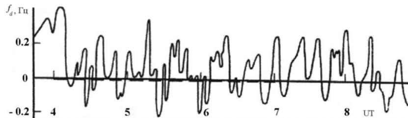
Рис. 14.2. Временные вариации доплеровского смещения частоты, сопровождавшие возмущение ионосферы мощным радиоизлучением
