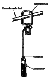
Рис. 33. Внешний вид одного из типов электроизмерительных клещей с выносным измерительным прибором
