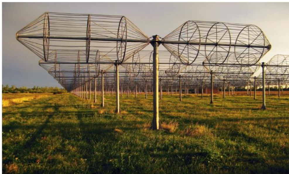
Рис. 2.6. Елемент антенної решітки УТР-2. Диполь Надененко.
